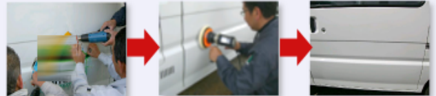
ステッカー等の剥離作業 磨いて日焼け跡を消す 跡が残らないキレイな状態
